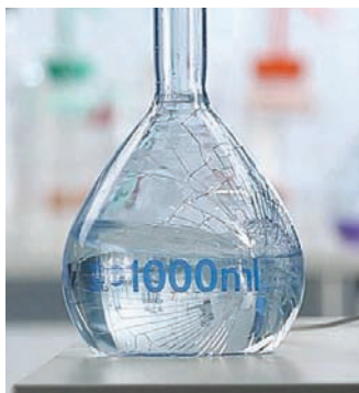
Matraz aforado con recubrimiento de plastico
